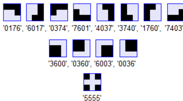
FIGURE 4.4 – les 8 variantes d'une pièce non symétrique et leurs codes. Pour les pièces symétriques, il y a généralement 4 variantes seulement sauf lorsqu'il y a 2 axes de symétrie qui réduit à 1 le nombre des variantes.
