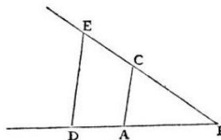
Soit par exemple  $AB$  l'unité, & qu'il faille multiplier  $BD$  par  $BC$ , ie n'ay qu'a joindre les points  $A$  &  $C$ , puis tirer  $DE$  parallèle a  $CA$ , &  $BE$  est le produit de cete Multiplication.
