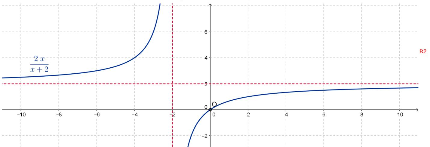
e) Application : lors d'un branchement en parallèle de deux résistances  $R_1$  et  $R_2$ , on peut remplacer ces deux résistances par une seule résistance  $R$  à condition de vérifier l'égalité  $\frac{1}{R} = \frac{1}{R_1} + \frac{1}{R_2}$ .
