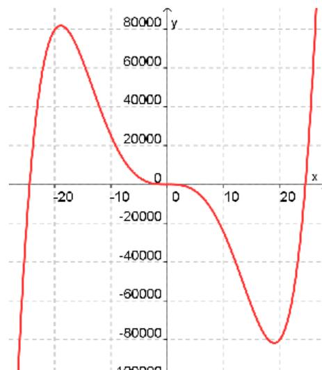
**Balayage** : Le principe du balayage est de découper le segment initial en fragments pour déterminer les bornes d'un nouvel intervalle, plus restreint, sur lequel on pourra recommencer. Il s'agit de la méthode de dichotomie si on partage le segment en deux à chaque fois. Mais l'idée ici est de le partager en un plus grand nombre de parties, par exemple en dix parties, ou en  $p$  parties,  $p$  étant paramétrable. Voici l'algorithme de balayage que nous proposons :
